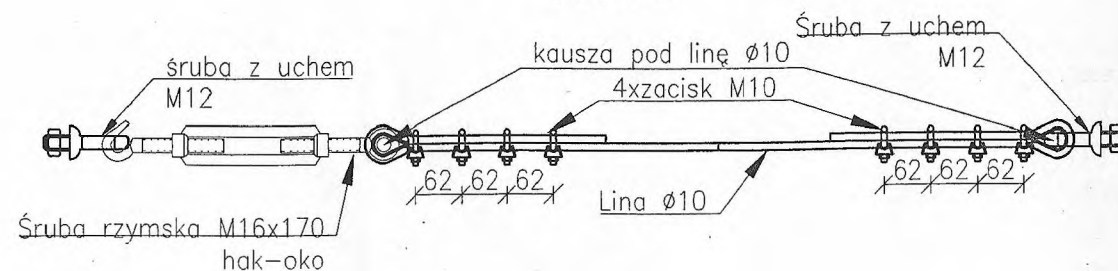
Schemat wykonania stężenia z liny stalowej skala 1:10
